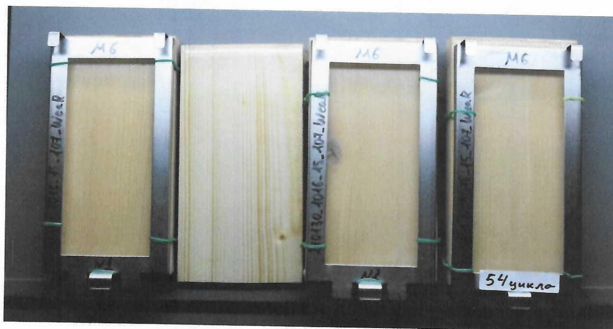
Рис. 5. Образцы после 54 циклов испытаний
